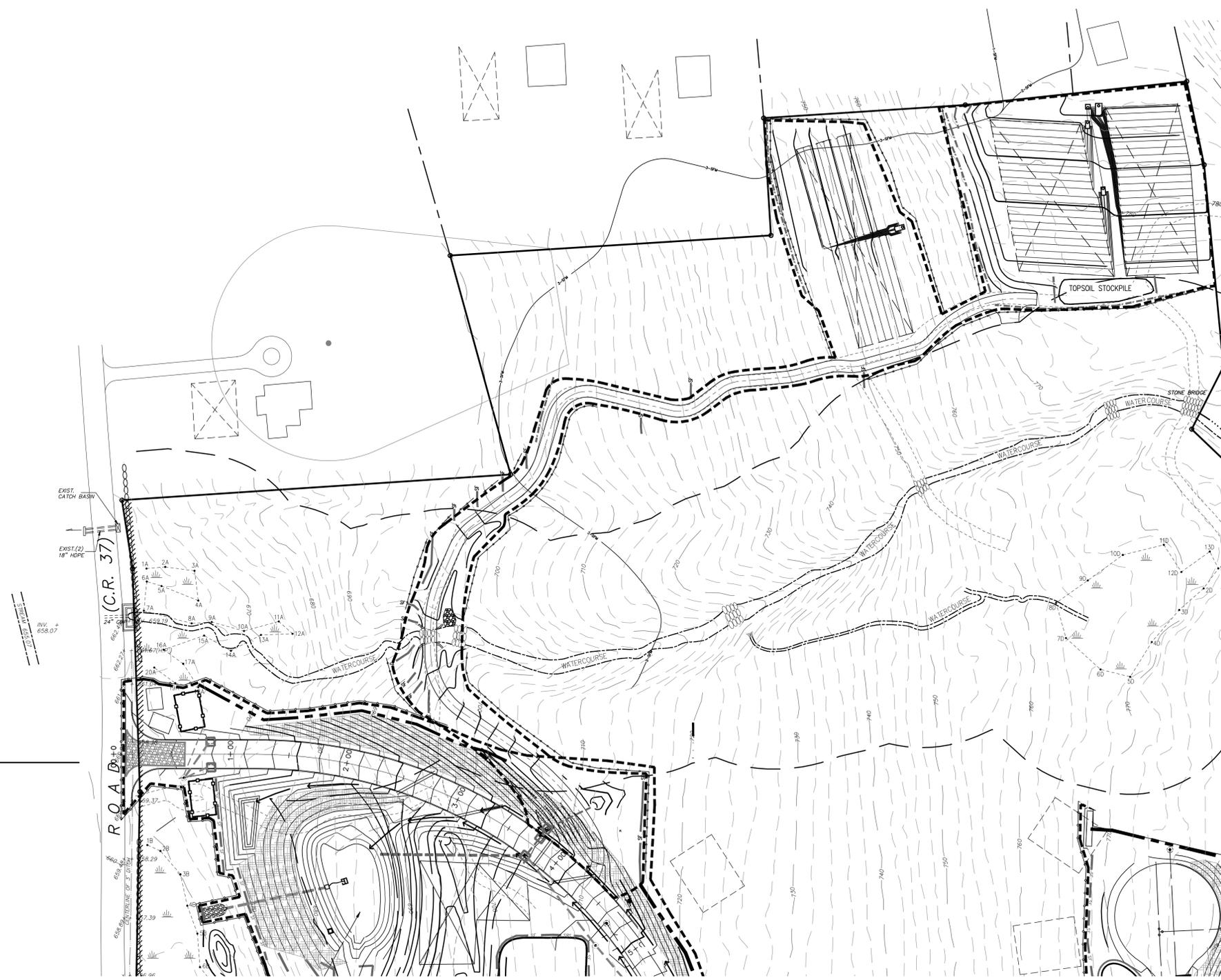
**EROSION & SEDIMENT CONTROL PLAN - PHASE I B**
